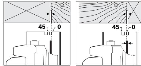
절단 표시 **0° (9)**는 직각 절단을 할 때 톱날의 위치를 나타냅니다. 절단 표시 **45° (8)**는 **45°** 각도로 절단할 때 톱날의 위치를 나타냅니다.
