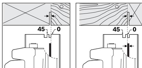
เครื่องหมายตัด  $0^{\circ}$  (9) แสดงตำแหน่งของใบเลื่อยสำหรับการตัดเป็นมุมจาก เครื่องหมายตัด  $45^{\circ}$  (8) แสดงตำแหน่งของใบเลื่อยสำหรับการตัด  $45^{\circ}$
