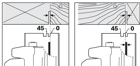
Tanda pemotongan  $0^\circ$  (9) menunjukkan posisi mata geraji pada pemotongan dengan sudut siku. Tanda pemotongan  $45^\circ$  (8) menunjukkan posisi mata geraji pada pemotongan dengan sudut  $45^\circ$ .
