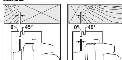
0 度角的鋸割記號 9，標示了直角鋸割時的鋸片位置。45 度角的鋸割記號 10，標示了 45 度角斜鋸時的鋸片位置。
