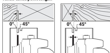
Tanda pemotongan **0°** **9** menunjukkan posisi mata gergaji pada pemotongan dengan sudut siku. Tanda pemotongan **45°** **10** menunjukkan posisi mata gergaji pada pemotongan dengan sudut 45°.
