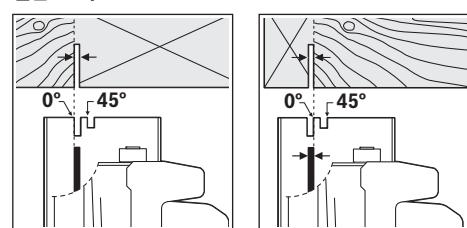
절단 표시 0° 9 는 직각 절단을 할 때 투날의 위치를 나타냅니다. 절단 표시 45° 10 는 45° 각도로 절단할 때 투날의 위치를 나타냅니다.
