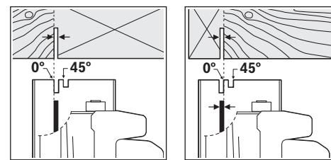
เครื่องหมายตัด 0° 9 แสดงตำแหน่งของใบเลือยกหัว การตัดเป็นมุมฉาก เครื่องหมายตัด 45° 10 แสดงตำแหน่งของใบเลือยกหัวการตัด 45°
